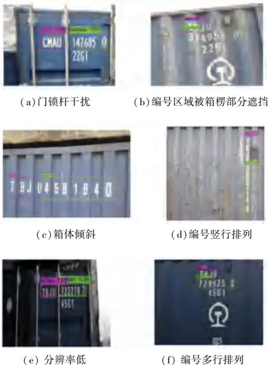
图6 各种条件下的集装箱编号定位结果
