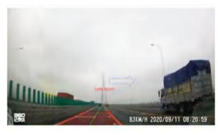
图 7 车道偏离预警实车测验效果图
