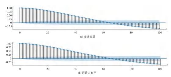
图 2 交通流量、道路占有率原始数据的自相关图
