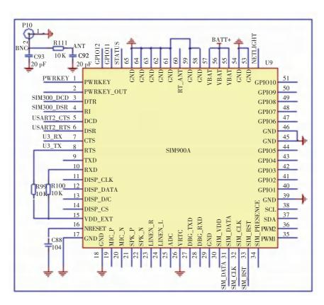
图 5 SIM900A 单元电路
