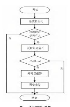
图 9 超声测距流程图
