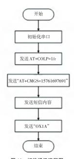
图 10 短信通讯流程图
