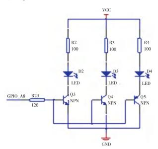
图 6 LED 灯照明输出电路
