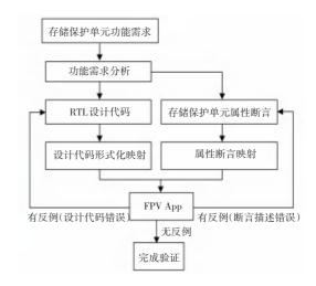
图 2 存储保护单元的断言验证流程
