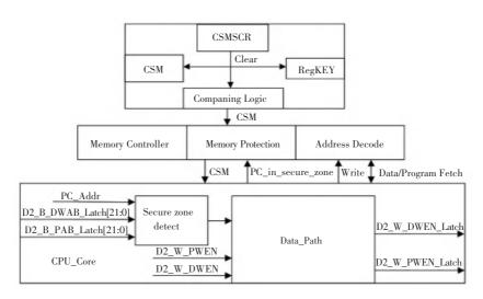
图 1 存储保护单元功能框图
