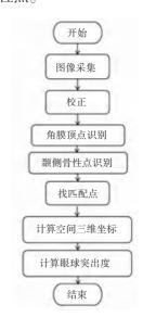
图 2 眼球突出度的双目视觉测量流程图
