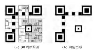
(a) The original image of QR code (b) The functional image 图 5 QR 码结构图
