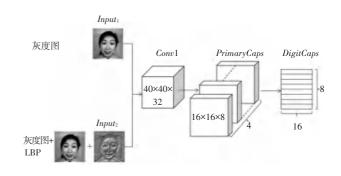
图 6 多通道输入胶囊网络
