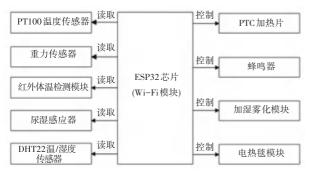
图 3 物理层和感知层框架设计
