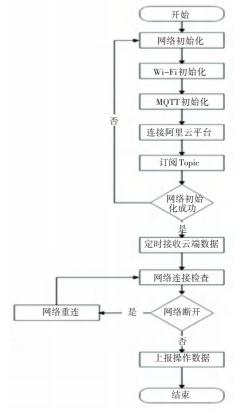
图 6 应用层设计流程图
